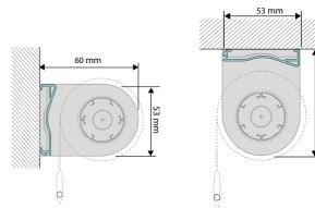
FENSTERFLÜGELBEFESTIGUNG mit Klemmträger smart Langloch MONTAGE met klemsteun en clip FIXATION ON THE WINDOW SASH with block holders
