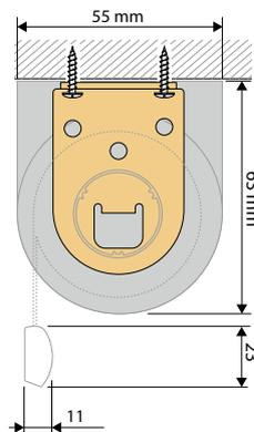
Träger wird optional für Rollos mit großer Höhe und großen Stoffdicken eingesetzt.
